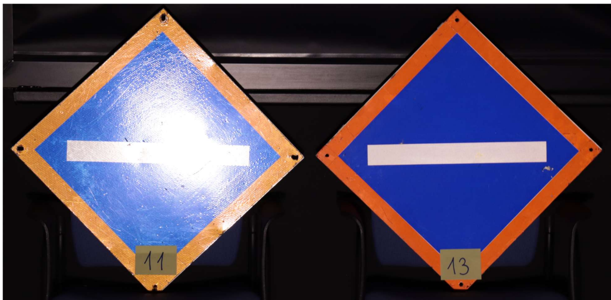
Obr. 12 Zrcadlová reflexe návěstidla třídy RA3 (vlevo)
