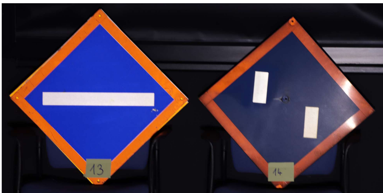
Obr. 15 Srovnání retroreflexe návěstidla třídy RA1 (vlevo) s nevyhovujícím návěstidlem (vpravo) jehož součinitel retroreflexe nedosahuje ani třídy RA1
