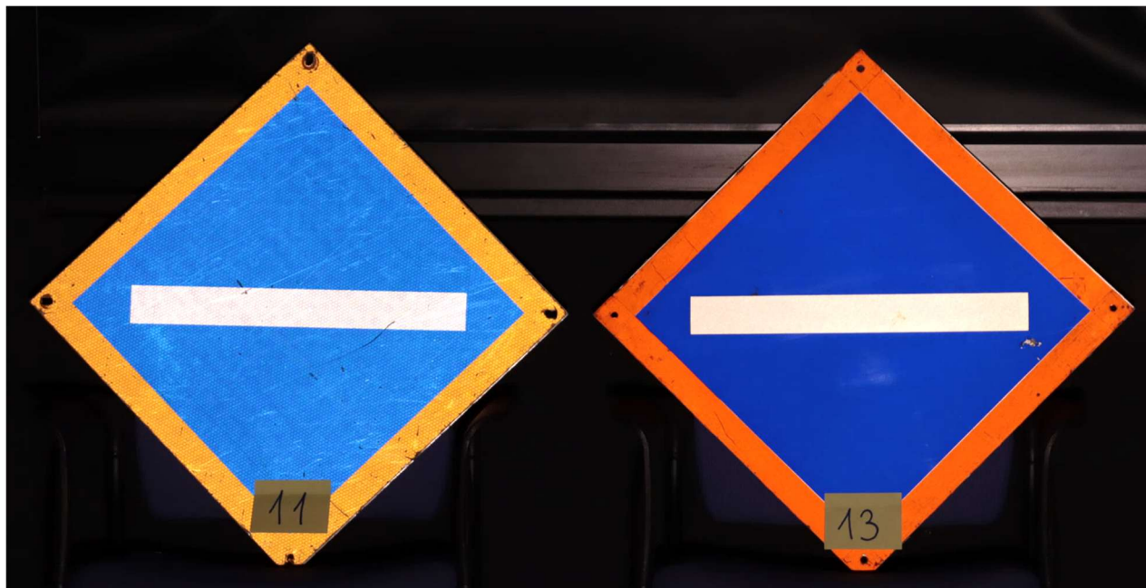
Obr. 9 Srovnání návěstidel s retroreflexí třídy RA3 (vlevo) a třídy RA1 (vpravo)
