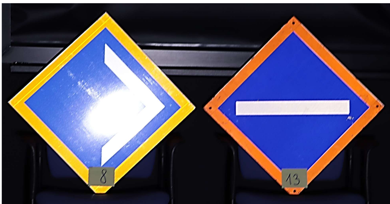
Obr. 13 Zrcadlová reflexe návěstidla třídy RA2 (vlevo)
