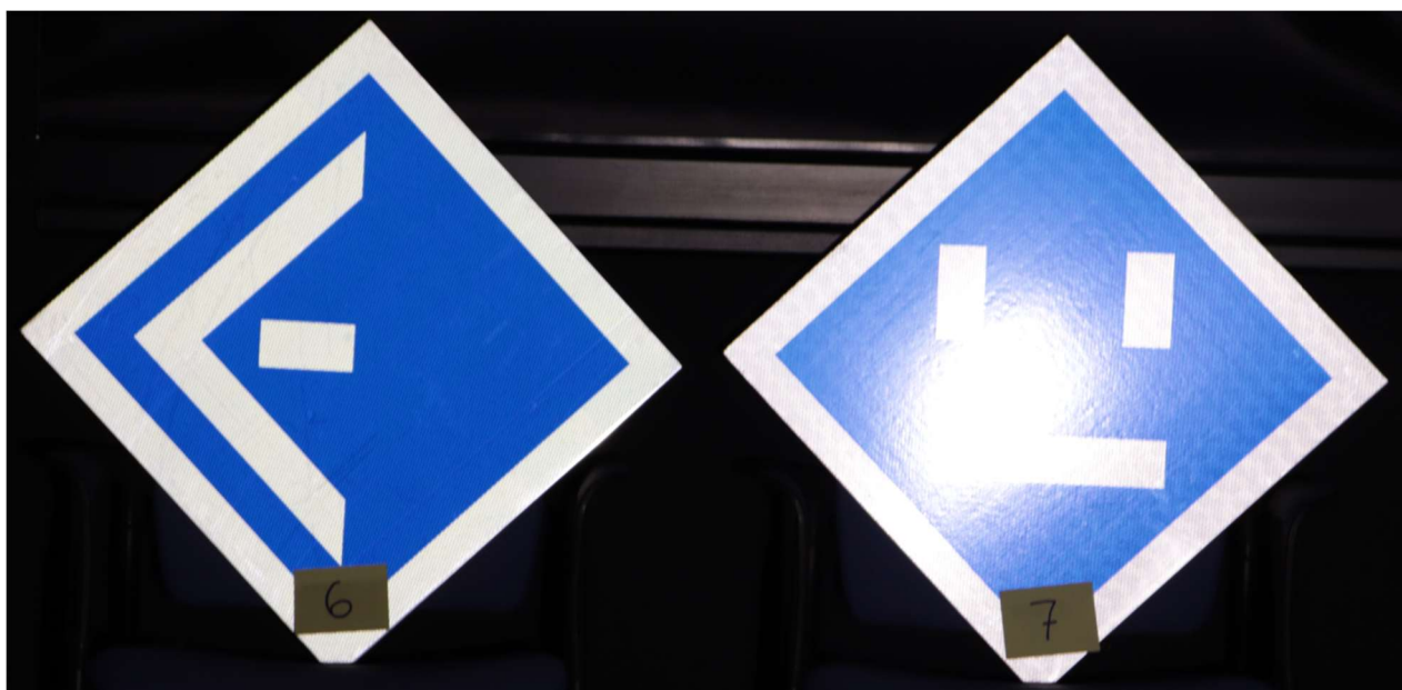
Obr. 17 Zrcadlová reflexe návěstidla třídy RA3 (vpravo)
