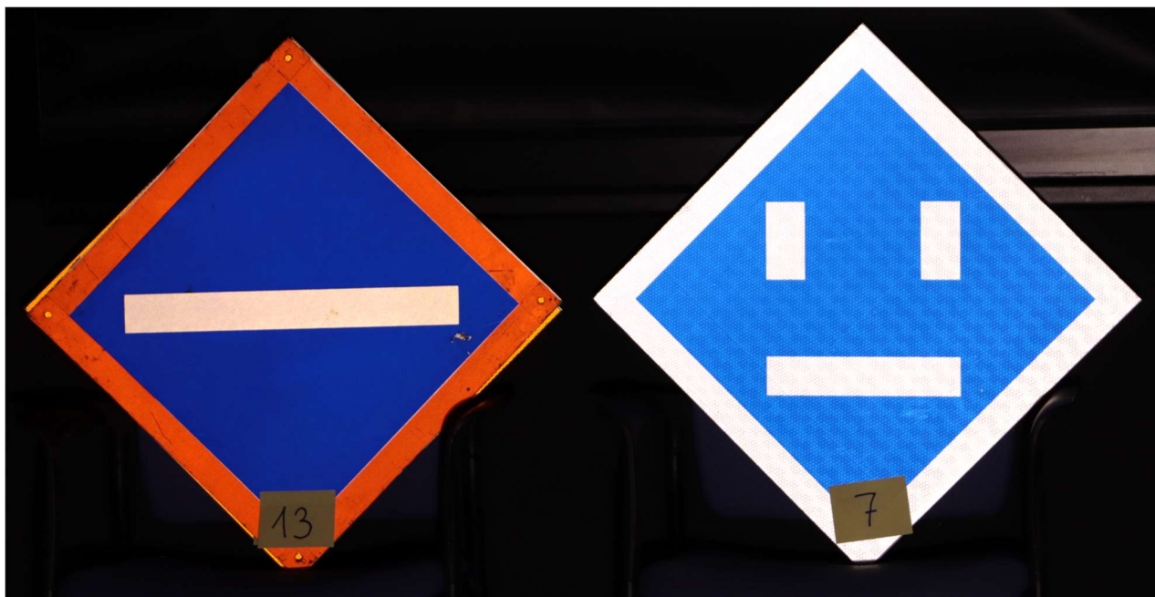
Obr. 16 Srovnání retroreflexe návěstidel třídy RA1 (vlevo) s třídou RA3 (vpravo)
