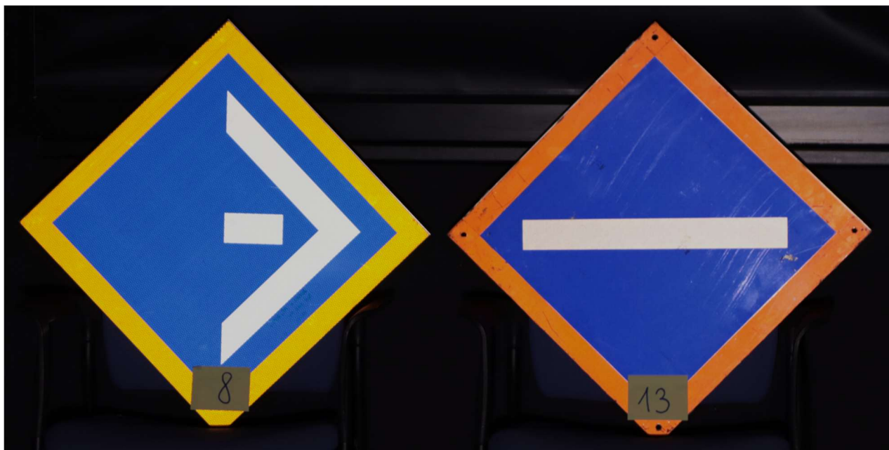
Obr. 10 Srovnání návěstidel s retroreflexí třídy RA2 (vlevo) a třídy RA1 (vpravo)
