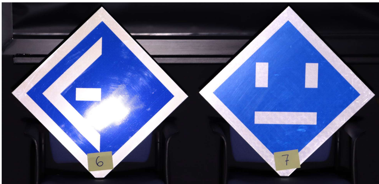
Obr. 18 Zrcadlová reflexe návěstidla třídy RA2 (vlevo)
